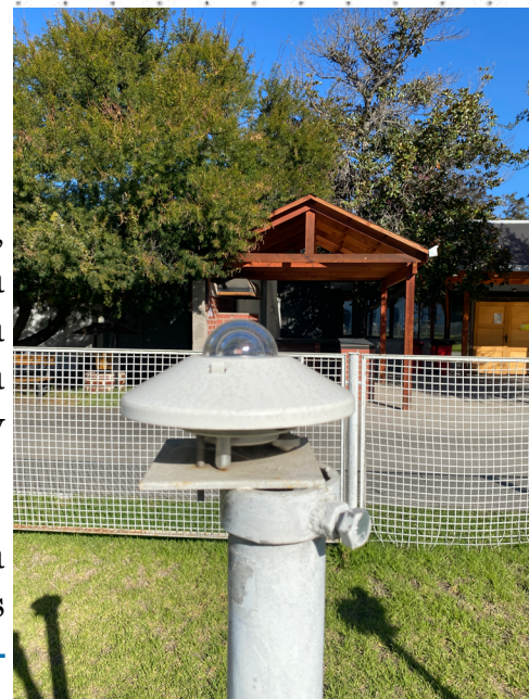
Figura 17. Piranómetro utilizado para medir radiación solar directa, estación meteorológica Quinta Normal, Santiago. Foto: Francisca Mendoza Arcos.
