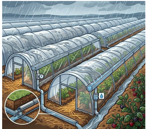
Figura 15. Canaletas y drenajes. Fuente: DMC, Sección Meteorología Agrícola. Elaboración propia.
